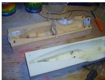
En fait j'ai fait un essai sur un demi moule avec du plâtre liquide et sur l'autre je l'ai laissé vierge. Le résultat est que le demi moule plâtré c'est un peu mieux démoulé mais ma demandé plus de travail de nettoyage. D'autre part, sur le demi moule plâtré certains détails fins ont été estompés... si c'était à refaire je laisserais le tout en brut avec seulement la vaseline.
