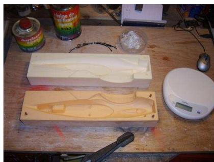
Ensuite j'ai huilé les demis moules avec de la vaseline puis commencer directement la stratification avec le couple de clef d'aile (CTP) et celui support du moteur électrique en CTP également.
