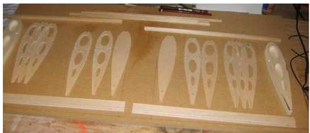
Les nervures sont découpées/fraisées en 2D avec la fraiseuse CNC.
